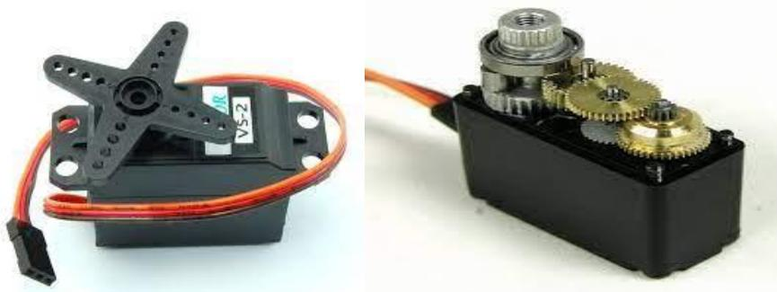
شكل رقم (6) : محرك الخطوة (Servo Motor)
