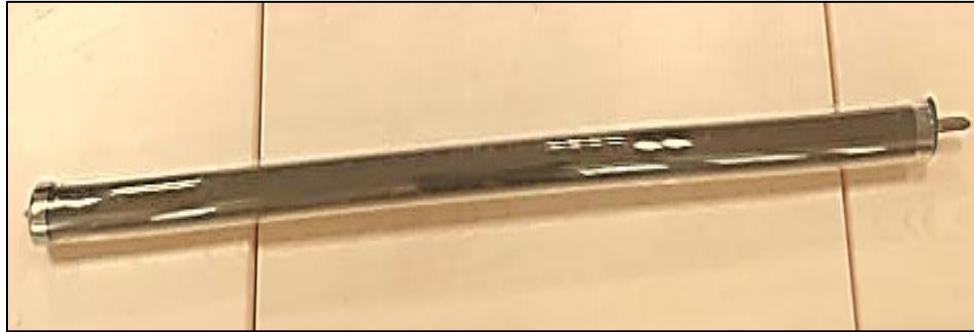
الشكل رقم(5): الأنبوب الحراري النحاسي المصمم داخل الأنبوب الزجاجي المفرغ
